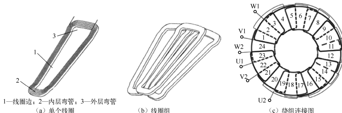
图1.19 三相8极无定子铁心双转子AFPM电机的定子绕组结构图
