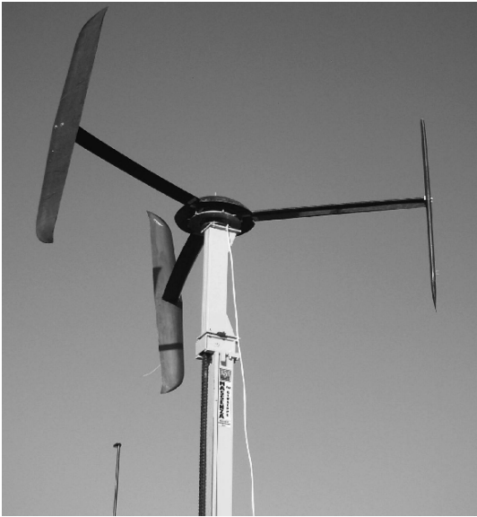
图 9.7 与垂直轴风力机集成的发电机 (由英国 Durham 大学和 Carbon Concepts 公司提供)
