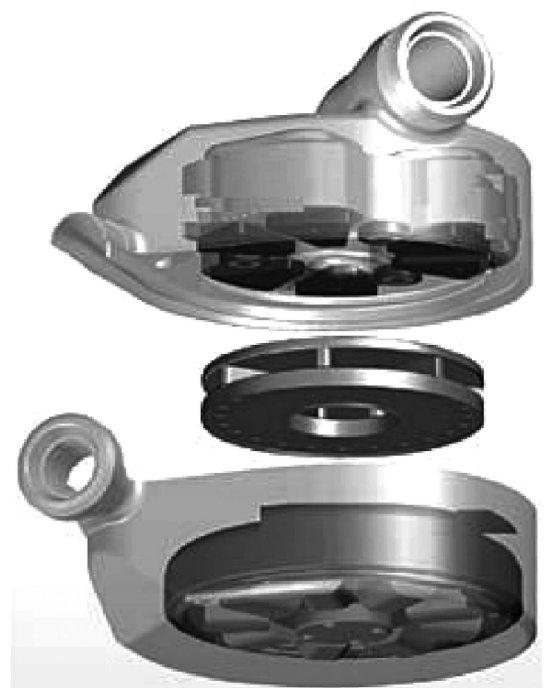
图 9.34 DuraHeart R 离心旋转泵的爆炸图（由日本 Terumo 公司提供）
