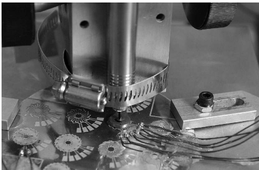
图 5.3 借助气动钻头在线圈上方旋转小型磁铁进行 AFPM 微型发电机的实验测试（由美国佐治亚理工学院提供）
