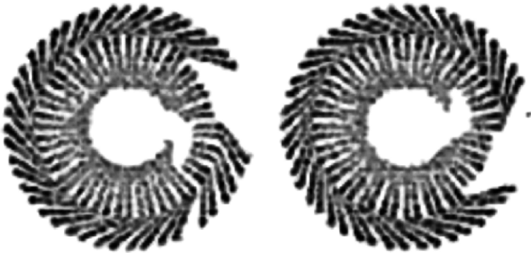
图 3.18 用于小型 AFPM 电机的薄膜线圈（由韩国 EMbest 公司提供）
